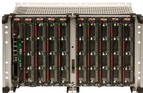
Abb. 4 OHP @250 Automatisierungs- und Fernwirkssystem
